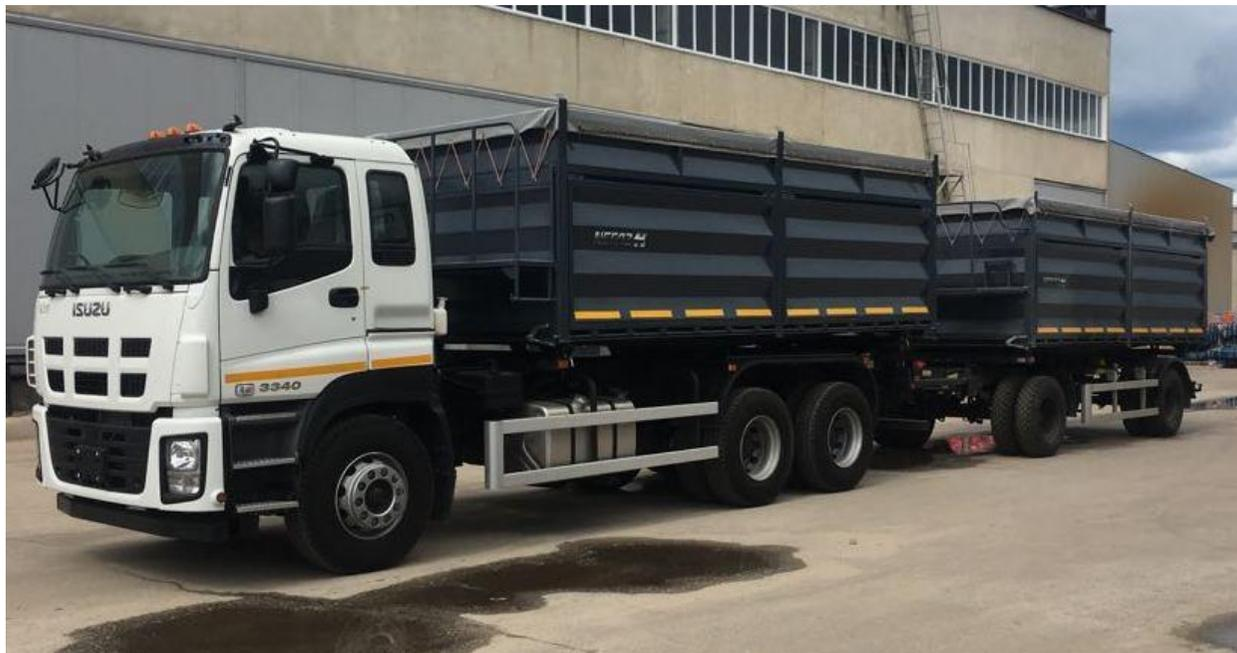
Автопоезд грузовой в составе автомобиля-самосвала модели 538984 (самосвальная установка 63340) на шасси Isuzu CYZ52P с ТСУ и самосвального прицепа модели 8560-02.
